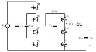
Fig. 1. Single-Phase ZIV Converter
